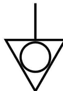
Das Gerät muss an ein Potentialausgleichssystem angeschlossen sein, dessen Wirksamkeit gemäß geltender Normen zweckmäßig geprüft wurde.
