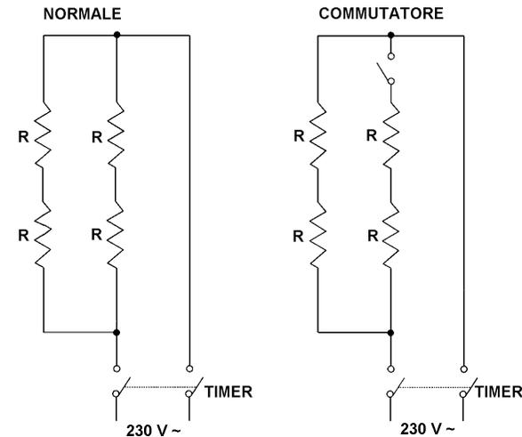
FIG. n°8 - Schema elettrico delle TOSTIERE: Q4; Q6
