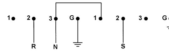
FIG. n°6 - schema elettrico delle PIASTRE: OPEN L/M/R
