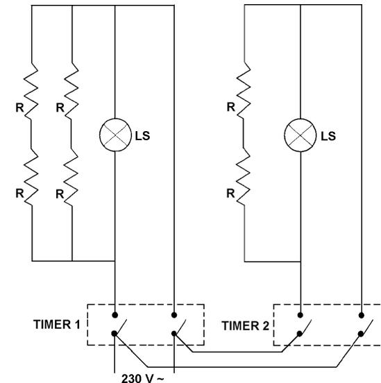
FIG. n°9 - Schema elettrico delle TOSTIERE: Q12
