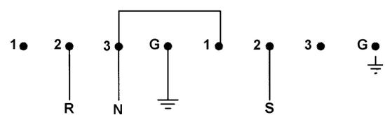
FIG. n°5 - schema elettrico delle PIASTRE: PM/R/L/3000
