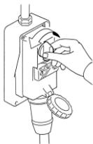
Disinserire il dispositivo di sezionamento generale e provvedere a proteggere la spina con appositi sistemi
